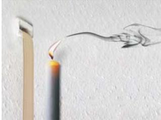
Diese kalte Zugluft lässt sich durch Dichtleitrollen einfach und kostengünstig verhindern.
