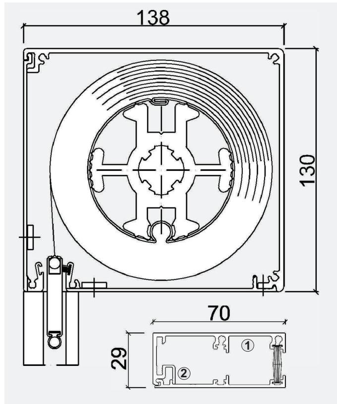
**Der dreiteilige Kasten** bietet für verschiedenste Einbausituationen Revisionsmöglichkeiten. Der Kasten ist entweder von unten oder seitlich zu öffnen.
