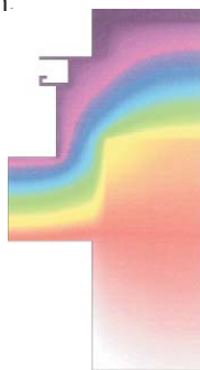
Optimaler Isothermenverlauf durch zusätzliche Dämmwirkung
